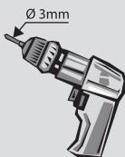
**\*F** -Pour minimiser l'apparition des fentes dans le bois, nous vous recommandons de percer un avant trou, avant de visser.
