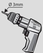
**F** -Pour minimiser l'apparition des fentes dans le bois, nous vous recommandons de percer un avant trou, avant de visser.
